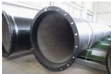
送水管（ダクタイル鉄管φ900mm）
